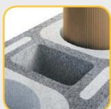
**Der dichte Mantelstein mit Wärmedämmung:** Wärmebrücken werden vermieden. Keine Kondensation am und im Lüftungszug.
